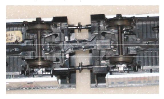
En la foto se ve ya montado el vagón con el dispositivo de enganche corto probándolo con su hermano para ver la compatibilidad de enganche y la distancia mínima entre topes. Esta es la prueba en anchura, pero se debe hacer también en altura:
